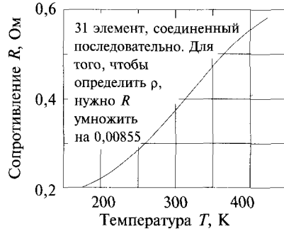
Рис. 5.16. Типичная зависимость коэффициента Зеебека и электрического сопротивления термопары от температуры
