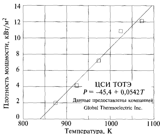
Рис. 7.7. Мощность ТОТЭ с циркониевым электролитом значительно увеличивается при увеличении температуры
