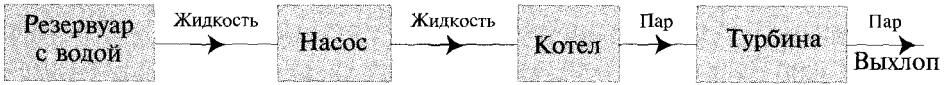
Рис. 3.5. В открытом цикле Ренкина отработанный пар отводится в окружающую среду. При этом требуется большой запас подводимой в систему воды
