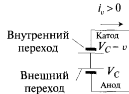
Рис. 12.9. Освещение внутреннего p,n -перехода приводит к снижению разности потенциалов на внутреннем переходе, что приводит к возникновению электрического тока
