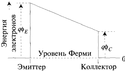
Рис. 6.8. Энергетическая диаграмма короткозамкнутого термоэмиссионного диода
